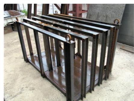
Изготовление стеллана на заготовительном участке для хранения небольших листовых заготовок (до 0,5 м)
